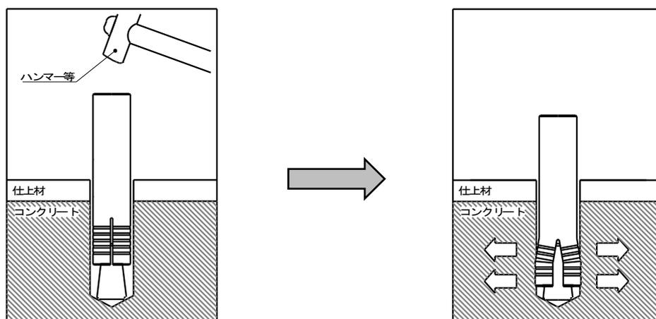
ハイアンカーWタイプは、本体を打ち込むことにより、先端にセットされたコーンのテーパーにそって拡張部が拡張しコンクリート孔壁に固着します。
