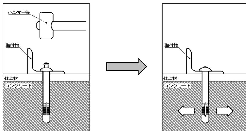
ハイアンカーTタイプは、本体に挿入されている芯棒を打込むことにより、本体の拡張部が開き、コンクリート孔壁に固着します。
